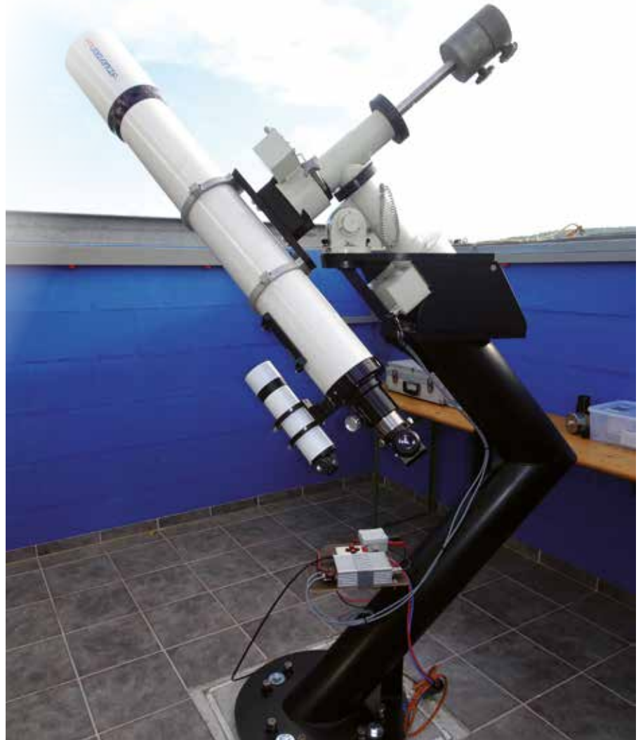
1 Knicksäule mit ALT-5 und Refraktor (Astrophysics Starfire)
